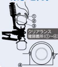
走行中にチェーンが車体と接触し、チェーン破損や事故の恐れがありますので、あらかじめ間隔を調べる必要があります。又、純正サイズ以外のタイヤ/ホイールやタイヤ周辺に純正以外の部品を使用されている場合には特に注意し、間隔を調べて下さい。
