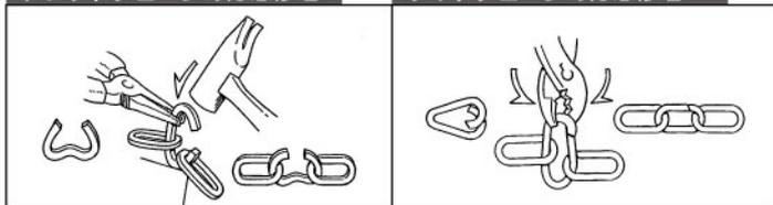
**Attention** チェーンが消耗し、切断した際には、付属補修パーツで図の様な応急修理をしてからご使用下さい。但し修理後は、時速10km以下、走行距離10km未満を限度に厳守下さい。その際、他の箇所も点検し、使用限度(P.6参照)を超えている場合は使用を中止して下さい。使用限度を超えて走行されるとチェーンは切断します。
